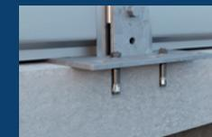
Pour un ancrage à l'aide de chevilles pour charges lourdes, vous devez prévoir une dalle en béton armé (~20-30 cm) ou une fondation en bande/par points (hors gel avec épaisseur de 80 cm).
